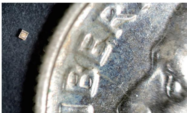
传感器网络的设计使芯片可以植入人体或集成到可穿戴设备中。每个亚毫米大小的硅传感器都能模拟大脑神经元通过尖峰电活动进行交流的方式。
