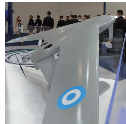
展览会上的“阿契塔”无人机,可见倒V型尾翼、推进式螺旋桨、装有2个电动螺旋桨的机翼呈展开状态、布置在机身中线后部的2个电动螺旋桨,机首下颚的天线等特征。
