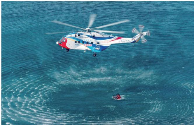
AC313是典型的单旋翼带尾桨直升机，最大起飞重量为13吨，可一次性搭载27名乘客，最大航程为1000千米。
