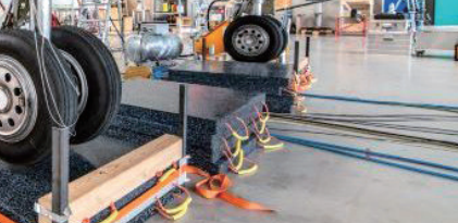
气动设备在测试起落架时重现环境条件。
