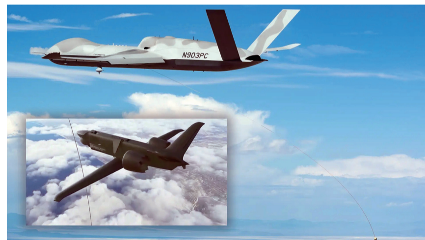
MQ-20“复仇者”喷气式无人机的牵引绳被展开。
