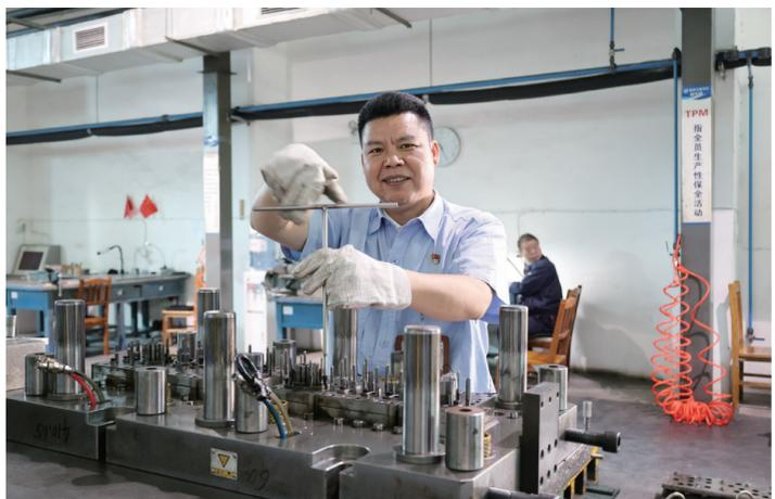
和工友讨论，下班回到家，就整理出来的问题点进行归纳。最终，他找到了问题，在与设计师沟通后，改进了该零件落料模型腔尺寸，将需要用切边模切掉的废料在落料模上完成，减少切边工序同时解决了毛刺大的问题。经过更改的工序，按照全年累计加工数量和切边定额来计算，可以节约公司六分厂小时费用率117.5元/小时，节省人工费用两千四百多元，节省成本两万二千余元。
