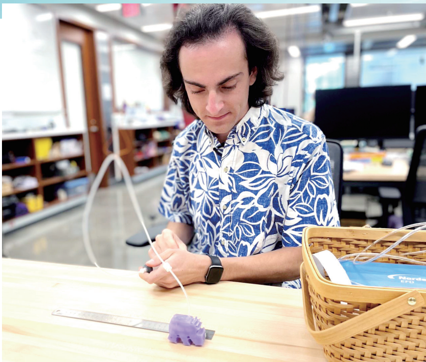
研究人员在橡胶机器人身体中注入空气，使其三条腿膨胀。当机器人身体内的空气瘪下去时，三条腿就会收缩。通过不断向机器人体内注入空气，它就会反复膨胀然后收缩，从而产生缓慢而稳定的运动。
