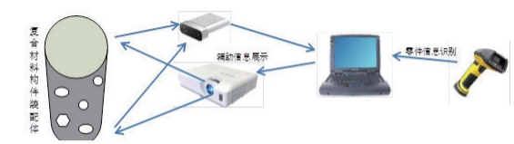
图2 基于视觉识别的人工作业辅助系统。
