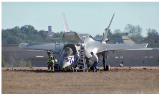
2018年，一架F-35A战机在美国佛罗里达州埃格林空军基地降落时，战机刚一停稳，前起落架突然收起，机头最昂贵的光电跟踪系统受损。
