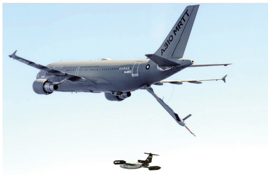
此次试验中，模拟受油无人机的Do-DT25被系统自动引导到硬管加油装置下方，距离A310MRTT仅几十米的距离。
