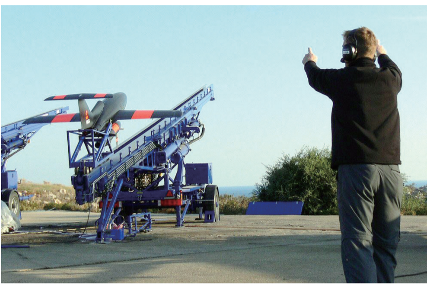
Do-DT25无人机系统，是衍生自空客出品的性能成熟的中途靶机无人机系统，本用于模拟红外目标，其起飞重量120千克、3米长、翼展2.5米，地面气动弹射起飞。
