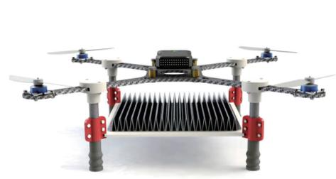
我国西北工业大学的研究人员展示了一种永远不需要降落的无人机，这要归功于一个远程充电系统，该系统通过地面上的自适应目标追踪激光器提供电力。该系统使用无人机底部的光电转换器来获取激光的能量。这类系统在无线电力传输方面做得相当不错，尽管转换效率并不高。
