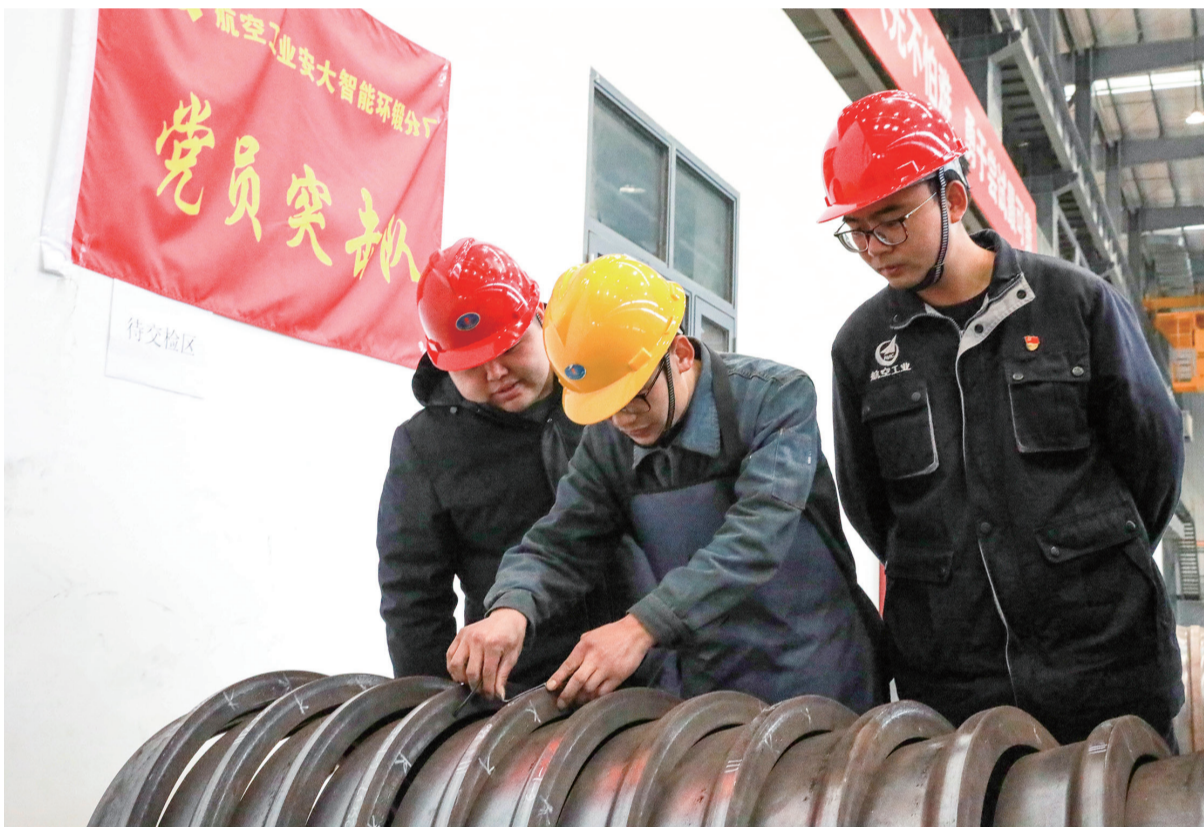
2月4日，新年上班第一个周末，航空工业安大智能环锻分厂成功完成外贸产品——LEAP发动机中间环锻件优化轧制。该发动机广泛装备于空客A320、波音737等民用客机，市场需求广阔。
