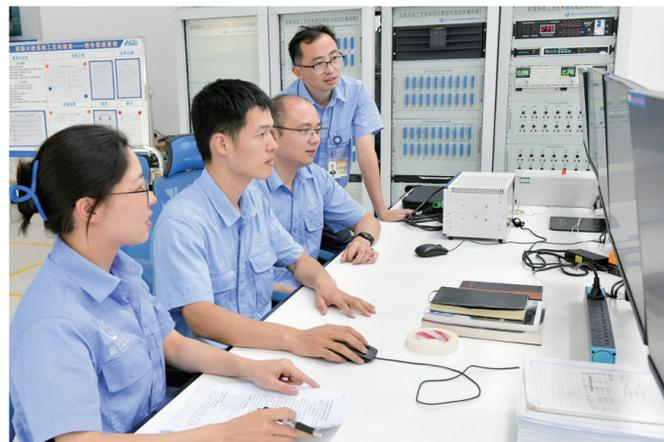
高度；这是无线电和导航系统，用于飞行员与地面联系……”江峰熟练地介绍着建成后试验室内的每个航电设备，最后指向AC311A模拟座舱说道：“以前因为公司没有航电系统的综合测试能力，航电成品发生故障时，常常只能求助成品厂家，需要花费大量的时间和人力，如今通过设备与仿真模拟座舱的联结，便可以根据显示屏的数据，辨别航电设备的故障。”
