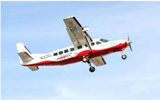
全电动飞机赛斯纳208B于5月28日完成首飞，从摩西湖的跑道上升起。该飞机在搭载4-5名乘客情况下，航程达到100英里（160千米），由MagniX公司的Magni500提供动力。这是迄今为止最大的全电动运输飞机，也意味着距离纯电动飞机投入运输市场又更近了一步。
