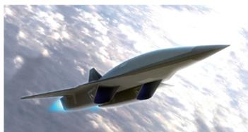
美国《大众科学》杂志6月报道了美国洛克希德·马丁公司（洛马公司）的SR-72高超声速打击一体飞机。该报道指出，SR-72将是一型以4000英里/时（6436千米/时）速度执行侦察任务并兼具打击能力的无人机。该机通过这种高达马赫数6的飞行速度来避免被攻击和实施侦察并打击目标，这一速度是SR-71高速战略侦察机（已于1998年退役）的两倍。该机能够从80000英尺（约24.4千米）高度打击目标。洛马公司表示该机将在2030年部署，可实现1小时内到达全球任何区域。
