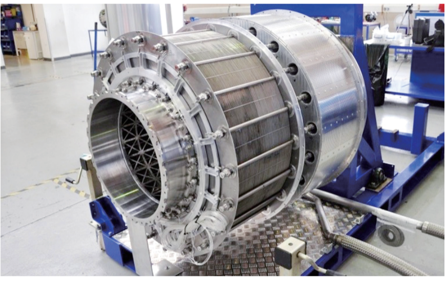
“佩刀”发动机核心技术——预冷器。
