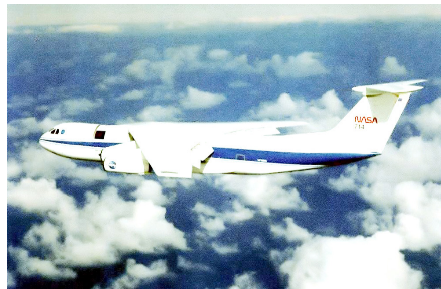
由 C-141 军用运输机改装的柯伊伯机载天文台。
