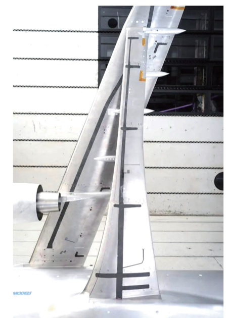
研究人员检查机翼根部和翼柱周围的抖振。
