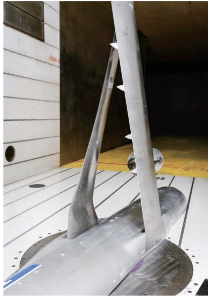
将翼柱从机翼下方移出，使其能够承载升力，并有助于提高飞机的空气动力学性能。
