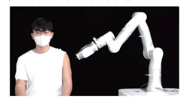
很多人害怕打针,未来 疫苗的接种能不能不使用针 头?目前同济大学开发了一 款无针头疫苗接种机器人,未 来有望解决无针注射问题。在 一个注射疫苗的模拟场景里, 接种机器人会拿起一个装有 药剂的小瓶,并使用其摄像 头传感器识别被接种者的身 体,自由旋转机械臂的角度, 从而找到最适合的接种部位。
