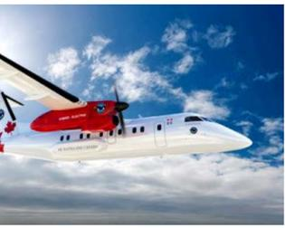
的目标是通过混合电推进技术将支线涡桨客机的燃油消耗和二氧化碳排放量降低30%。演示验证将基于加拿大德哈维兰公司“冲锋”8飞机平台开展，应用柯林斯航空公司提供的先进电动机与控制器。柯林斯航空公司与普惠公司同属于雷神技术公司。
