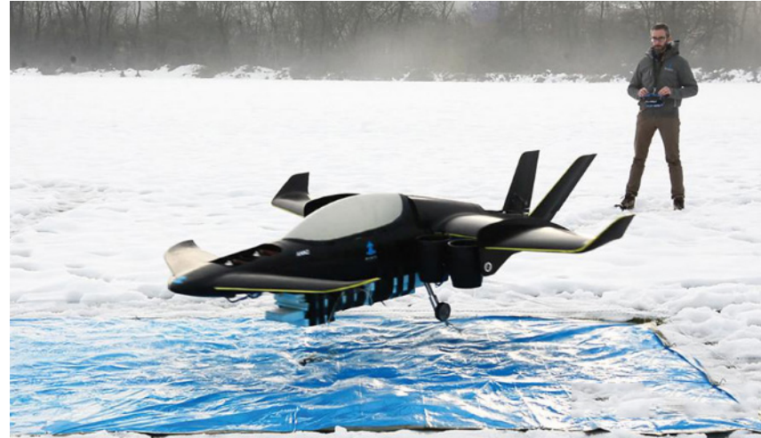
1/3比例的缩比模型用于开发曼塔混合电推进VTOL/STOL的ANN2的飞行控制软件。
