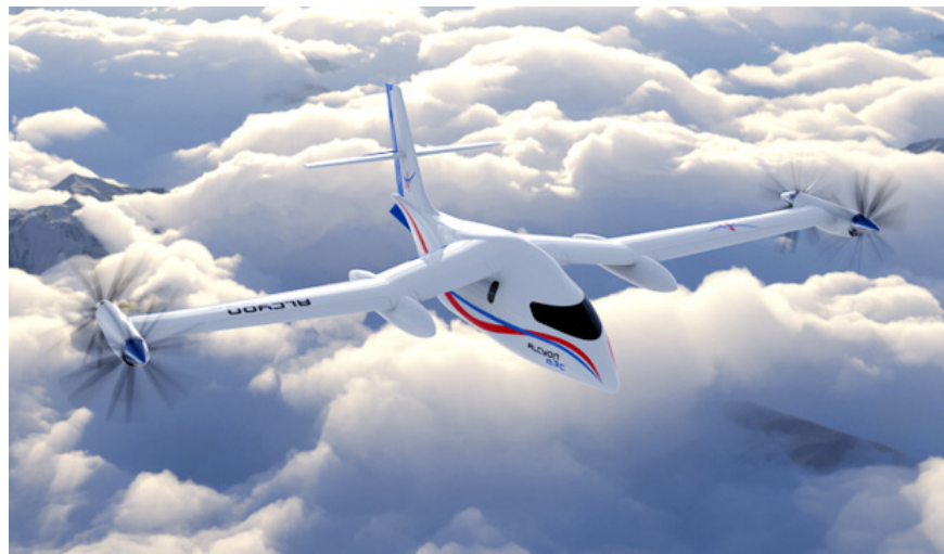
6座Alcyon机型采用与双座Alerion相同的混合电推进系统以及分布式布局。
