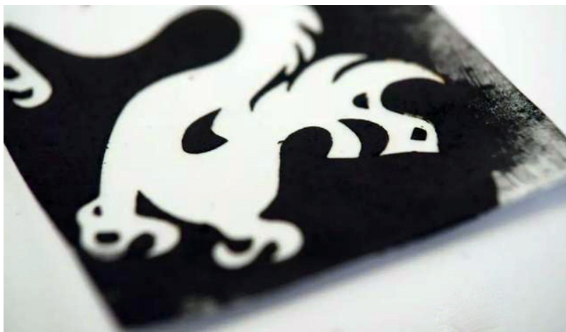
由 MXene 喷涂而成的天线
