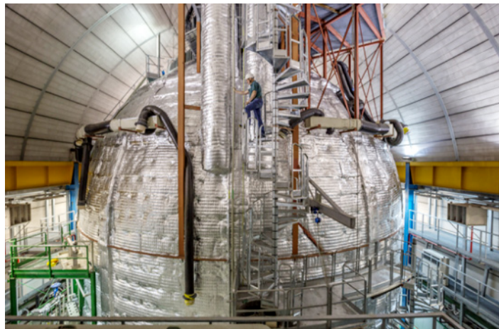
Borexino中微子探测器，在外侧包裹隔热材料来精细控制探测器温度。
