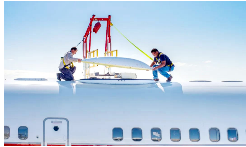
霍尼韦尔航空航天的 Jetwave 卫星通信终端就是一个能够抑制干扰的 Ka 频段信号接收器。
